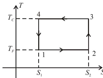
On a vu que  $|W| = \text{aire du cycle dans le diagramme } (T, S)$ .
