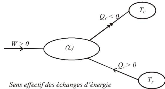
Le premier et le deuxième principe de la thermodynamique pour un système **fermé** décrivant une évolution **cyclique**
