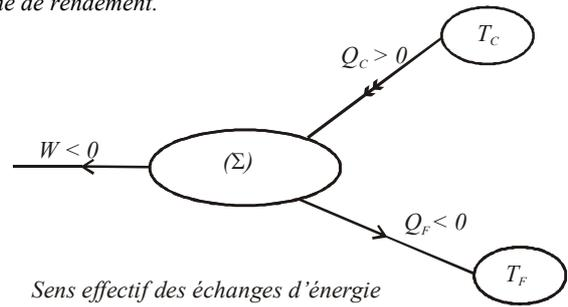
Le premier et le deuxième principe de la thermodynamique pour un système **fermé** ( $\Sigma$ ) avec une transformation **cyclique ditherme** s'écrivent (voir I.1 page 1) :
