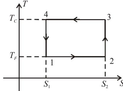
On a vu que  $|W| = \text{aire du cycle dans le diagramme } (T, S)$ .
