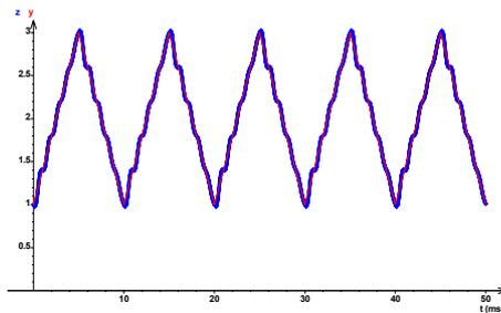
**Programme Regressi : triangle de fréquence 100 Hz – filtre de fréquence propre 1000 Hz.**
