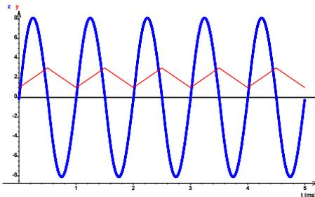
**Programme Regressi : triangle de fréquence 1000 Hz – filtre de fréquence propre 1000 Hz.**
