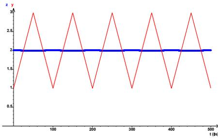
**Programme Regressi : triangle de fréquence 10000 Hz – filtre de fréquence propre 1000 Hz.**
