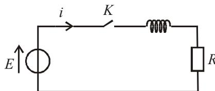
À  $t = 0^+$ ,  $i = 0$  car l'intensité ne peut pas varier de façon discontinue dans une bobine.
