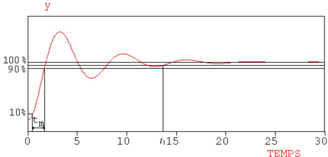
Le **temps de montée**  $t_m$  est l'intervalle de temps séparant les instants auxquels la réponse indicielle vaut 10% et 90% de la valeur finale.
